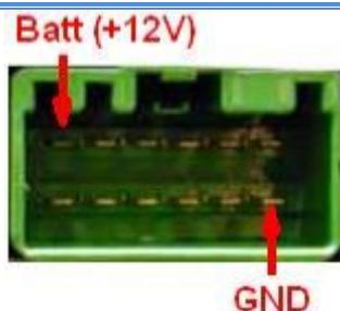
Красный провод адаптера соединить с контактом "Batt" (+12В постоянный).
